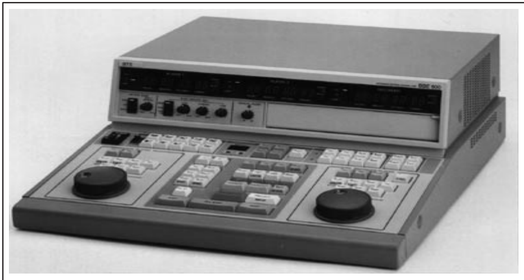
Abb. 3.2.b Die BBE 600 Editing Control Unit von BTS, ein typischer Videocontroller
